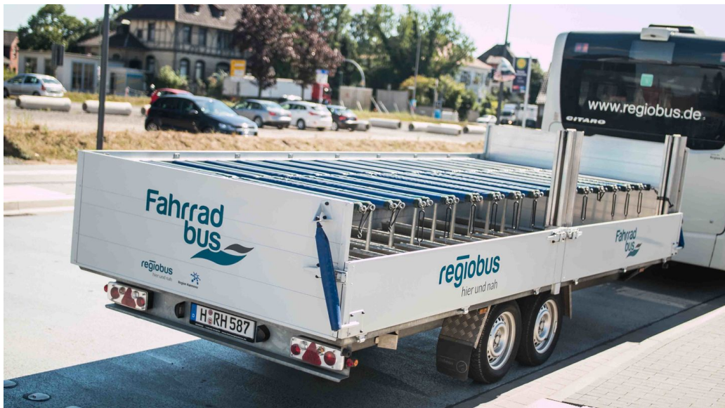
Abb. 60: Fahrradanhänger mit Seitenbeladung (Foto: Regiobus Hannover)
